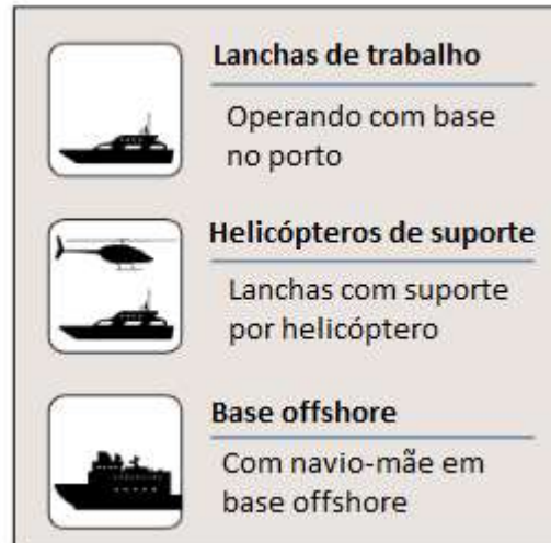
Figura 12: Estratégias de manutenção para plantas offshore. Fonte: adaptado de GL Garrad Hassan (2013)
