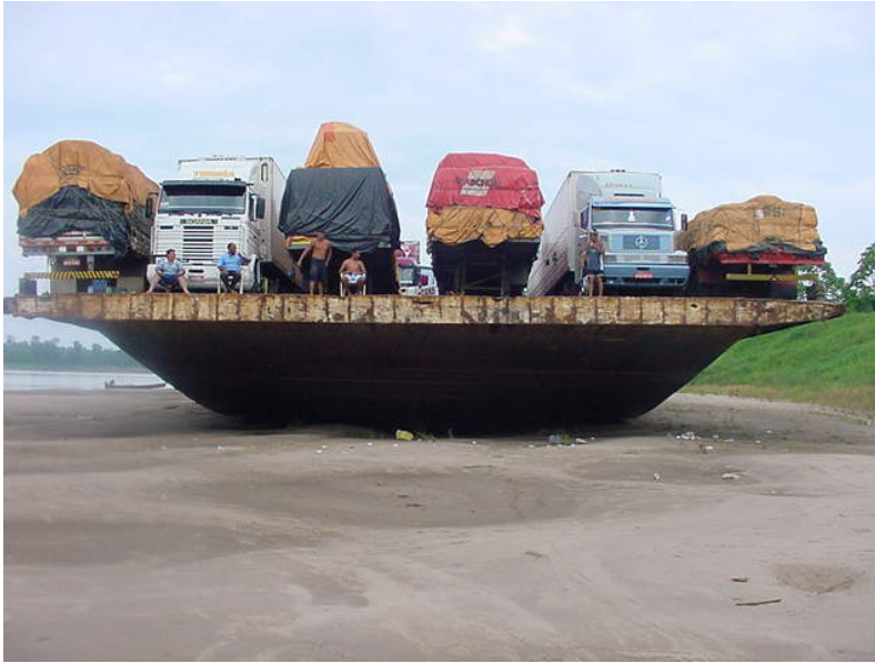
Figura 54: Encalhamento de balsas e dragagem para desencalhar
