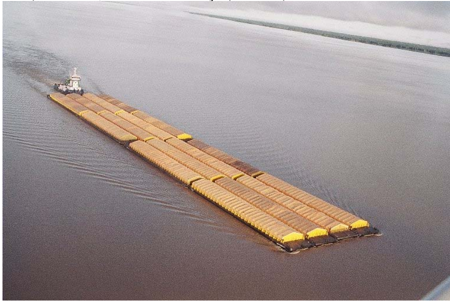
Figura 52: Comboio graneleiro de 34.000 ton no rio Madeira (270mx44m) Calado 3,80 m Uma barcaça (60x11m)
