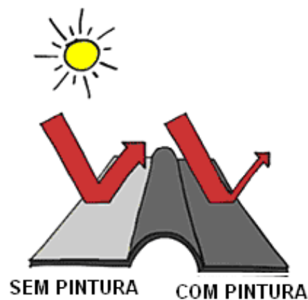
Figura 4-5- Efeito da pintura da placa absorvedora
