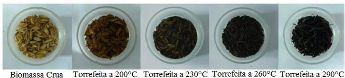
Figura 3.6: Casca de arroz torrefeita a diferentes temperaturas
