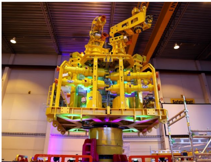
Figura 15 - Caping Stack System (CCS) de propriedade da OSRL.
