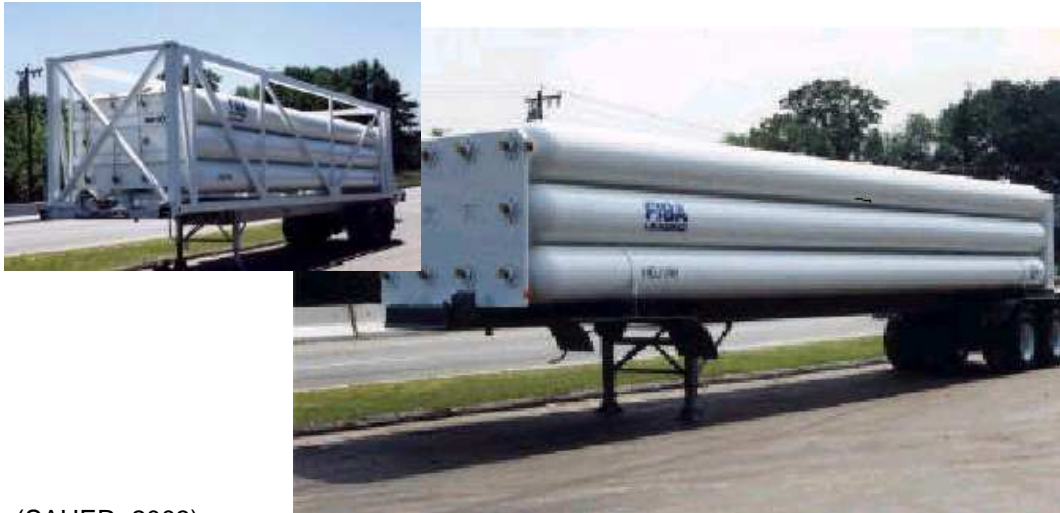
Figura 39: Tecnologia de transporte de gás natural comprimido – caminhão feixe.
