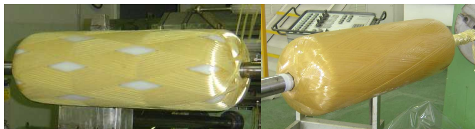
Figura 48: Cilindros leves em fibra de Kveler sendo bobinados sobre liner de plástico.
