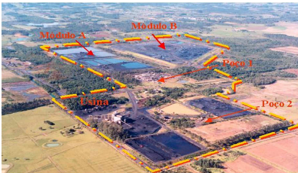
Figura nº.11. Foto aérea oblíqua da planta industrial pertencente à Carbonífera Criciúma S.A.. O contorno em amarelo e vermelho representa os canais periféricos do sistema de drenagem superficial.
