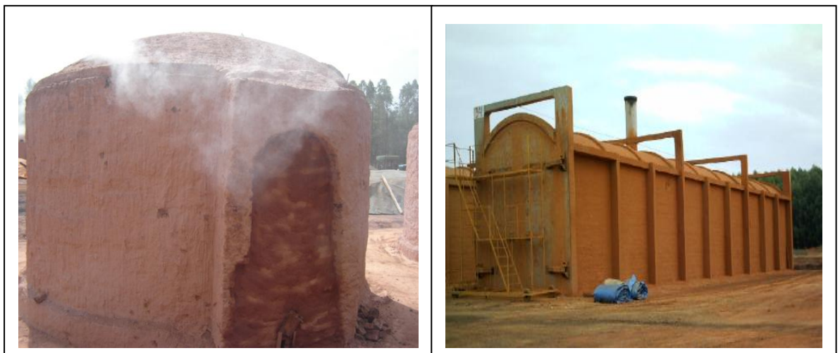
Figura 6. Fornos de Alvenaria: Colméia e Retangular.
