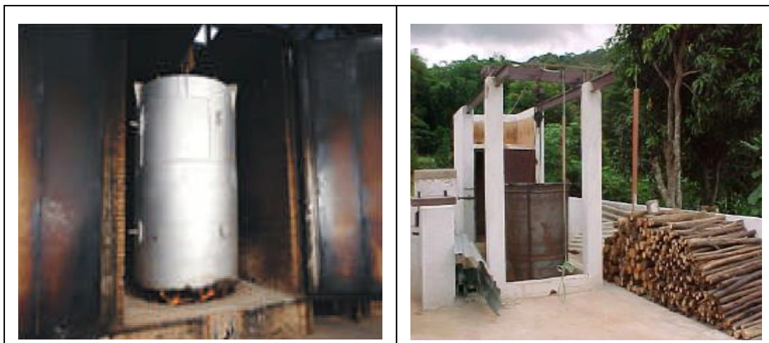
Figura 7. Vista de fornos metálicos para carbonização
