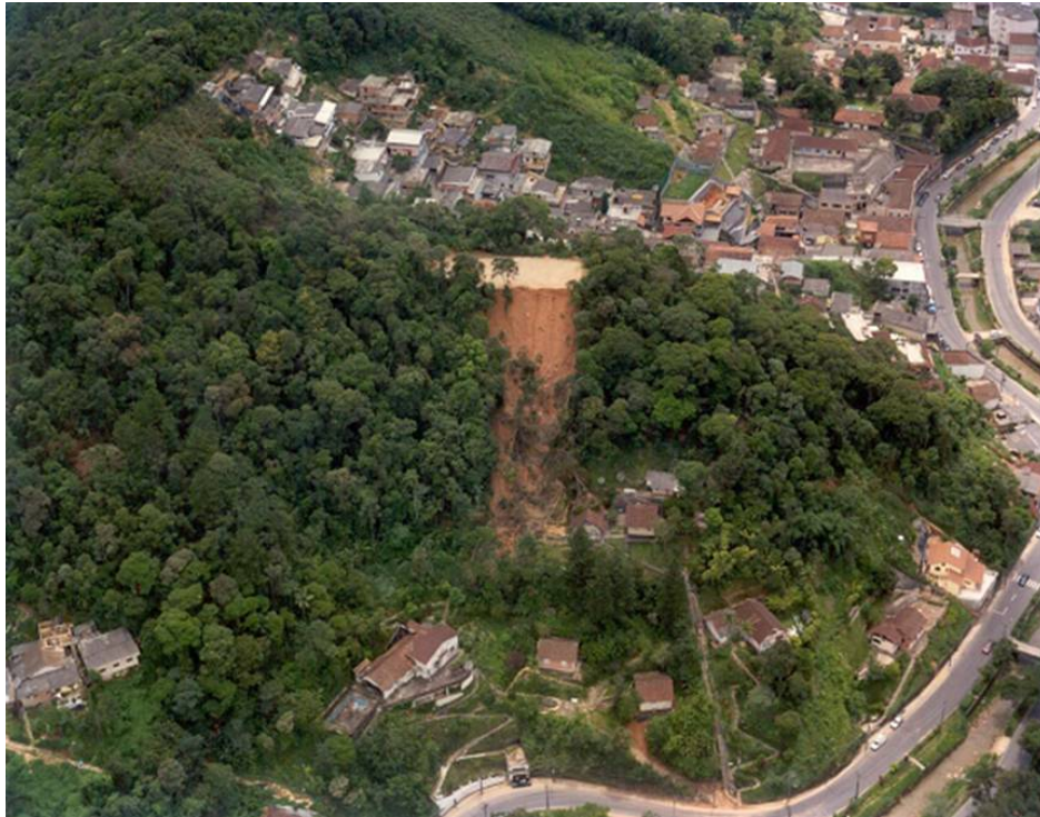
Figura 3.4 - Escorregamentos de aterro gerado por terraplenagem. Petrópolis, dezembro de 2001. Fonte: OLIVEIRA (2004).
