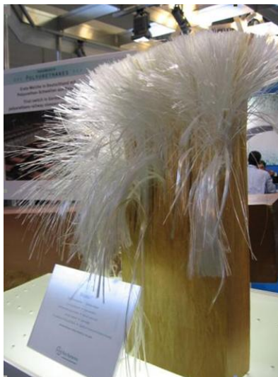
Figura 1 – Poliuretano com fibra de vidro usado na fabricação de dormentes ferroviários
