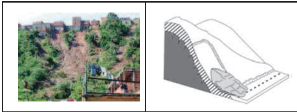
Figura 2 – Foto e Perfil esquemático do Deslizamento Planar ou Translacional. Fonte: Extraída e adaptada de CARVALHO; MACEDO; OGURA (2007, p. 35).
