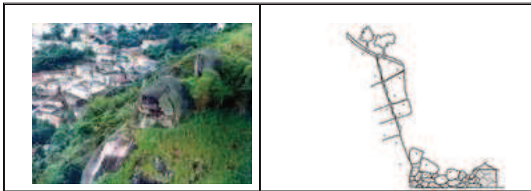
Figura 5 – Foto e Perfil esquemático da Quedas de blocos e/ou lascas Fonte: Extraída e adaptada de CARVALHO; MACEDO; OGURA (2007, p. 38).
