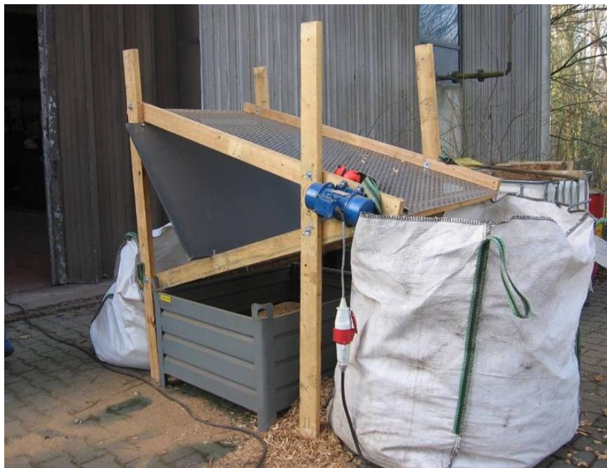
Figura 26 – Imagem do dispositivo de triagem em operação
