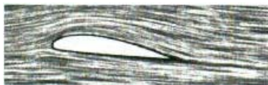
Figura A1.19 - Fluxo aderente ao perfil
