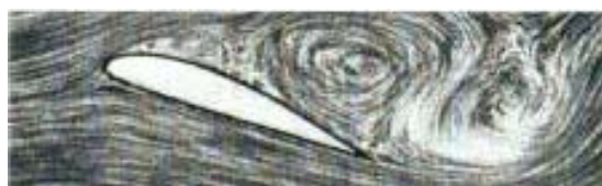
Figura A1.21 - Fluxo separado (estol) em volta do perfil
